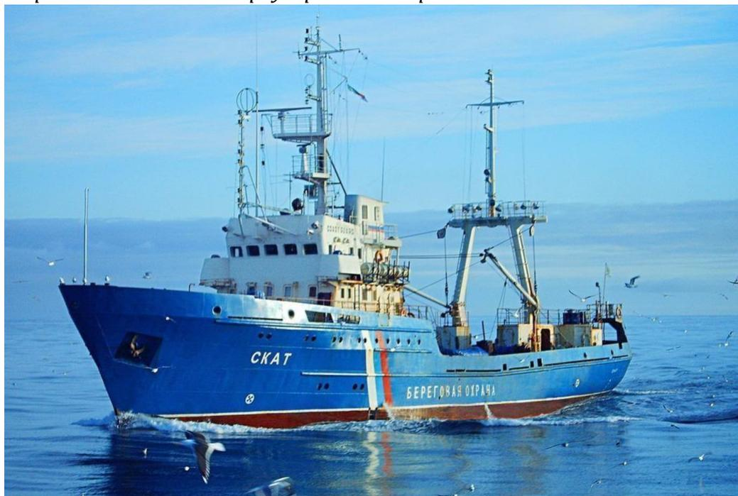
Рыболовный траулер СТР-503 пр. предназначен для добычи и переработки, транспортировки рыбы в замороженном виде к месту реализации готовой мороженой продукции. Траулер рассчитан для добычи рыбы тралом за один заход до 150
